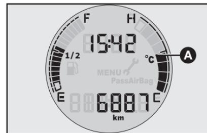
El encendido continuo de la señalización de reserva en el cuadro de instrumentos y el mensaje "FUEL" indican que en el depósito quedan todavía 5,5 a 7,5 litros de combustible.
